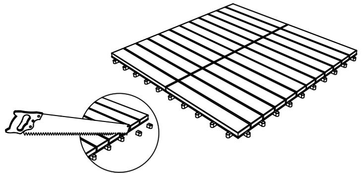
Corte los conectores expuestos en las orillas para obtener una apariencia mas agradable.
