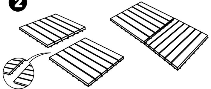
Conecte el sistema macho-hembra para comenzar el ensamblado.
